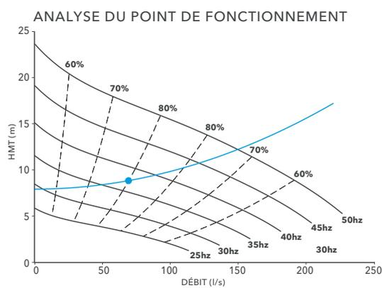
En calculant à chaque marnage une nouvelle fréquence, SmartRun trouve la fréquence optimale correspondant à l'énergie spécifique minimale. Ainsi SmartRun évite tout fonctionnement à des fréquences trop basses pour lesquelles la consommation d'énergie augmente.
