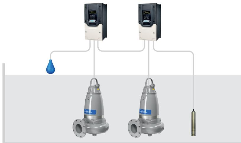
Exemple d'installation SmartRun : deux pompes, deux SmartRun, un régulateur de niveau et un capteur de pression analogique.
